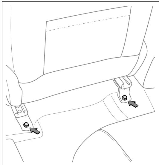
(c). 拆卸前排电动座椅后部固定螺栓。
