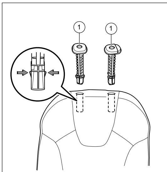
(d). 按压前排电动座椅头枕导向件固定卡。
