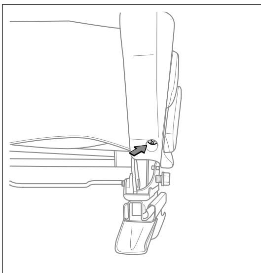
(b). 安装手动驾驶员座椅右侧饰板固定螺栓并紧固。
