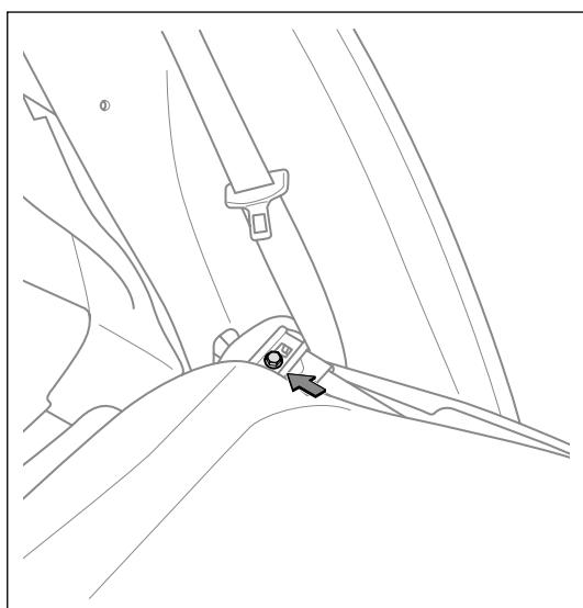
(d). 拆卸后排座椅单人靠背固定螺栓。
