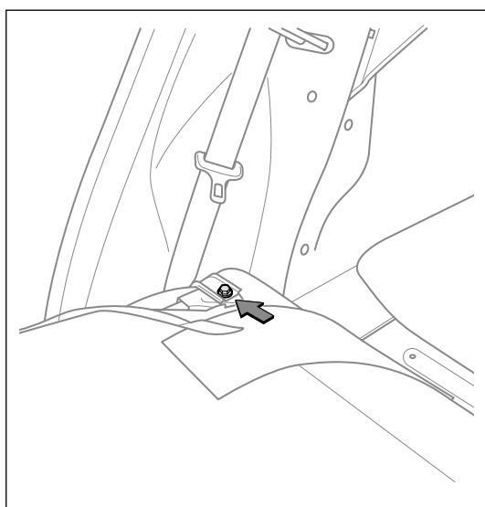
(d). 拆卸后排座椅双人靠背固定螺栓。
